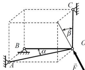
Три стержня  $AO$ ,  $BO$  и  $CO$  шарнирно-стержневой конструкции соединены в точке  $O$ , к которой приложена сила  $F = 18H$ . Определить усилия в стержнях  $AO$ ,  $OC$  и  $OB$ , если углы  $\alpha = 30^\circ$ ,  $\beta = 45^\circ$ .
