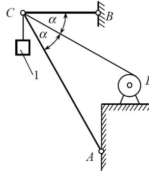
Определить реакцию стержня  $AC$ , удерживающего в равновесии груз  $1$  весом  $14H$  с помощью цепи, намотанной на барабан  $D$  и перекинутой через блок  $C$ , если угол  $\alpha = 30^\circ$ . Определить также усилие в стержне  $BC$ .
