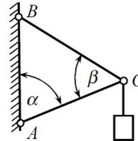
Шарнирный трёхзвенник  $ABC$  удерживает в равновесии груз, подвешенный к шарнирному болту  $C$ . Вес груза  $Q = 6,7H$ . Заданы углы  $\alpha = 60^\circ$  и  $\beta = 45^\circ$ . Считая стержни  $AC$  и  $BC$  невесомыми, определить усилие в стержнях  $AC$  и  $BC$ .
