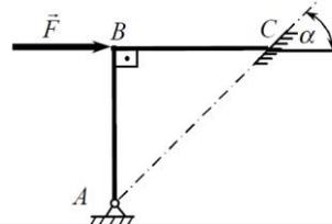
Изогнутый стержень  $ABC$  прикреплен к полу посредством шарнира  $A$ , а другой его конец  $C$  свободно опирается на гладкую плоскость, образующую угол  $\alpha = 45^\circ$  с горизонтом. Определить реакции шарнира и плоскости, если на стержень действует сила  $F = 10H$ .
