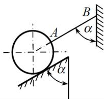
Однородный шар весом  $12H$  удерживается в равновесии на гладкой наклонной плоскости с помощью веревки  $AB$ . Определить давление шара на плоскость, если угол  $\alpha = 60^\circ$ . Определить также натяжение веревки  $AB$ .
