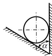
Однородный шар весом  $40H$  опирается на две плоскости, пересекающиеся под углом  $\alpha = 60^\circ$ . Определить давление шара на наклонную плоскость и на вертикальную плоскость.
