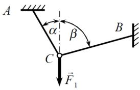
Определить модуль силы  $\vec{F}_3$  натяжения троса  $BC$  и натяжение троса  $AC$  -  $\vec{F}_2$ . В положении равновесия углы  $\alpha = 30^\circ$  и  $\beta = 75^\circ$ , сила  $F_1 = 10H$ .
