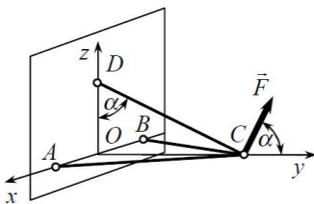
Три стержня  $AC$ ,  $BC$  и  $DC$  соединены шарнирно в точке  $C$ . Определить усилие в стержне  $DC$ , если заданы сила  $F = 50H$  и угол  $\alpha = 60^\circ$ . Сила  $\vec{F}$  находится в плоскости  $yOz$ .
