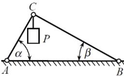
Два невесомых стержня  $AC$  и  $BC$  соединены в точке  $C$  и шарнирно прикреплены к полу. К шарниру  $C$  подвешен груз  $P$ . Определить реакцию стержня  $BC$ , если усилие в стержне  $AC$  равно  $43H$ , углы  $\alpha = 60^\circ$ ,  $\beta = 30^\circ$ . Определить также вес груза  $P$ .
