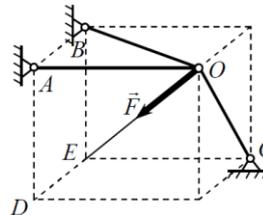
Три стержня  $AO$ ,  $BO$  и  $CO$  соединены в шарнире  $O$ . Определить реакцию стержня  $CO$ , возникающую под действием силы  $F = 12H$ , приложенной к шарниру  $O$ , если расстояния  $AB = AO = AD$ . Сила  $\vec{F}$  направлена по  $OE$ .
